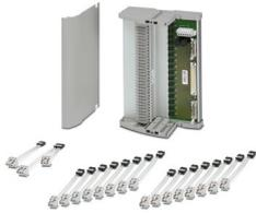
Termination Carrier universel pour la connexion de 16 amplificateurs-séparateurs MACX Analog Ex i à des cartes E/S TOR ou analogiques, via connecteurs D-SUB, 37 pôles (liaison 1:1), avec raccordement de multiplexeur HART
