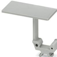
Etiquette de repérage de groupes de bloc de jonction, s'encliquette au centre des blocs de jonction à vis, à ressort ou pour raccordement rapide, repérage avec une étiquette 25 x 12 mm ou manuellement à l'aide du stylo B-STIFT, au niveau du pied avec ZB 5
