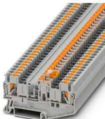
Bloc de jonction à couteau de sectionnement, tension nominale: 400 V, intensité nominale: 16 A, type de raccordement: Raccordement Push-in, Section de référence: 2,5 mm<sup>2</sup>, section : 0,14 mm<sup>2</sup> - 4 mm<sup>2</sup>, montage: NS 35/7,5, NS 35/15, coloris: gris
