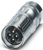
Connecteurs à câble, droit, SPEEDCONNEC, M17, nombre de pôles: 5+3+PE, type de contact: Mâle, blindé: oui, cote de bride: 25,75 mm x 25,75 mm, indice de protection: IP67, plage de diamètre de câble: 8 mm ... 10 mm, nombre de pôles: 9, type de raccordement: Raccordement à sertir, série: ST, Produit de remplacement selon RoHS II sans exception 6c (Pb < 0,1 %) référence : 1242798
