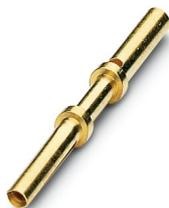
Contact à sertir, Connecteur femelle, tournés, diamètre de contact: 0,6 mm, zone de sertissage: 0,34 mm<sup>2</sup> ... 0,5 mm<sup>2</sup>, Produit de remplacement selon RoHS II sans exception 6c (Pb < 0,1 %) référence : 1242315
