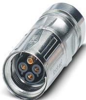
Connecteurs à câble, droit, SPEEDCONNEC, M17, nombre de pôles: 5+3+PE, type de contact: Connecteur femelle, blindé: oui, cote de bride: 25,75 mm x 25,75 mm, indice de protection: IP67, plage de diamètre de câble: 8 mm ... 10 mm, nombre de pôles: 9, type de raccordement: Raccordement à sertir, série: ST, Produit de remplacement selon RoHS II sans exception 6c (Pb < 0,1 %) référence : 1242805
