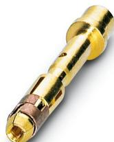
Contact à sertir, Connecteur femelle, tournés, diamètre de contact: 1 mm, zone de sertissage: 0,25 mm<sup>2</sup> ... 1 mm<sup>2</sup>, Produit de remplacement selon RoHS II sans exception 6c (Pb < 0,1 %) référence : 1243216
