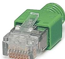
Connecteur RJ45, type: RJ45, indice de protection: IP20, nombre de pôles: 8, 1 Gbit/s, CAT5 (CEI 11801:2002), matériau: Plastique, type de raccordement: Raccordement à sertir, section raccordable: AWG 26- 24, sortie du câble: droit, coloris: gris, Ethernet
