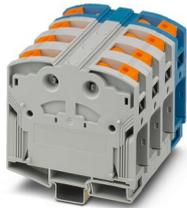
Bloc de jonction de puissance, bloqué, tension nominale: 1000 V, intensité nominale: 309 A, nombre de connexions: 8, nombre de pôles: 4, type de raccordement: Raccordement PowerTurn, 1er étage, section : 95 mm<sup>2</sup> - 185 mm<sup>2</sup>, type de montage: NS 35/15, coloris: gris/bleu
