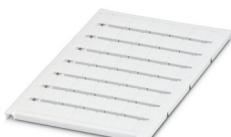
Repères pour blocs de jonction, Planche, blanc, vierge, repérable avec : BLUEMARK ID COLOR, BLUEMARK ID, BLUEMARK CLED, PLOTMARK, CMS-P1-PLOTTER, type de montage: encliquetage, pour bloc de jonction au pas de : 12 mm, surface utile: 11,45 x 10,5 mm, Nombre d'étiquettes: 40
