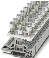
Connecteur de puissance, tension nominale: 1000 V, intensité nominale: 125 A, nombre de connexions: 2, type de raccordement: Raccordement par tige filetée, Section de référence: 35 mm<sup>2</sup>, type de montage: NS 35/7,5, NS 35/15, coloris: gris
