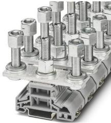
Connecteur de puissance, tension nominale: 1000 V, intensité nominale: 269 A, nombre de connexions: 2, type de raccordement: Raccordement boulonné, Section de référence: 120 mm<sup>2</sup>, type de montage: NS 35/7,5, NS 35/15, coloris: gris
