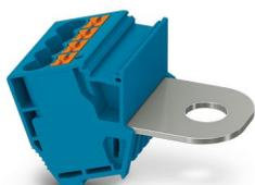
Bloc de jonction de dérivation, tension nominale: 1000 V, intensité nominale: 41 A, nombre de connexions: 5, type de raccordement: Raccordement Push-in, 1er étage, Section de référence: 6 mm<sup>2</sup>, section : 0,5 mm<sup>2</sup> - 10 mm<sup>2</sup>, Raccordement boulonné, 1er étage, type de montage: sur embase, coloris: bleu
