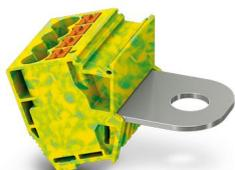
Bloc de jonction de dérivation, tension nominale: 1000 V, intensité nominale: 41 A, nombre de connexions: 5, type de raccordement: Raccordement Push-in, 1er étage, Section de référence: 6 mm<sup>2</sup>, section : 0,5 mm<sup>2</sup> - 10 mm<sup>2</sup>, Raccordement boulonné, 1er étage, type de montage: sur embase, coloris: vert/jaune
