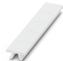
Ruban de repérage ZB, à commander : par bandes, blanc, impression selon les indications du client, type de montage: encliquetage dans la rainure de repérage élevée, pour bloc de jonction au pas de : 12,2 mm, surface utile: 10,5 x 12,15 mm, Nombre d'étiquettes: 5
