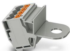
Bloc de jonction de dérivation, tension nominale: 1000 V, intensité nominale: 41 A, nombre de connexions: 5, type de raccordement: Raccordement Push-in, 1er étage, Section de référence: 6 mm<sup>2</sup>, section : 0,5 mm<sup>2</sup> - 10 mm<sup>2</sup>, Raccordement boulonné, Raccordement collectif, type de montage: sur embase, coloris: gris
