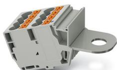
Bloc de jonction de dérivation, tension nominale: 1000 V, intensité nominale: 41 A, nombre de connexions: 9, type de raccordement: Raccordement Push-in, 1er étage, Section de référence: 6 mm<sup>2</sup>, section : 0,5 mm<sup>2</sup> - 10 mm<sup>2</sup>, Raccordement boulonné, 1er étage, type de montage: sur embase, coloris: gris
