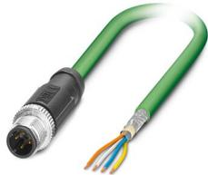
Câble de réseau, PROFINET CAT5 (100 Mbit/s), EtherCAT® CAT5 (100 Mbit/s), 4-pôles, blindé (Advanced Shielding Technology), connecteur mâle droit M12, détrompage: D / IP67, sur extrémité libre, longueur de câble: 50 m
