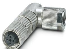
Connecteur de données, PROFINET CAT5 (100 Mbit/s), 4-pôles, blindé, connecteur femelle coudé M12, D, Raccordement à sertir, matériau de la molette: Zinc moulé sous pression, étamé, diamètre extérieur du câble 4,5 mm .. 7,5 mm, sans contacts à sertir
