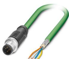
Câble de réseau, PROFINET CAT5 (100 Mbit/s), EtherCAT® CAT5 (100 Mbit/s), 4-pôles, Type de câble variable, blindé, connecteur mâle droit M12, détrompage: D SPEEDCONNEX / IP67, sur extrémité libre, longueur de câble: Longueur au choix (0,2... 40,0 m)
