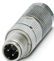
Connecteur de données, PROFINET CAT5 (100 Mbit/s), 4-pôles, blindé, connecteur mâle droit M12, D, Raccordement à sertir, matériau de la molette: Zinc moulé sous pression, étamé, diamètre extérieur du câble 4,5 mm ... 7,5 mm, sans contacts à sertir
