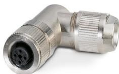
Connecteur de données, PROFINET CAT5 (100 Mbit/s), 4-pôles, blindé, connecteur femelle coudé M12, D, Raccordement autodénudant, matériau de la molette: Laiton, nickelé, diamètre extérieur du câble 4 mm ... 8 mm
