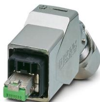
Connecteur RJ45, indice de protection: IP65/IP67, nombre de pôles: 8, 1 Gbit/s, CAT5, matériau: Métal, type de raccordement: Raccordement autodénudant IDC, section raccordable: AWG 23- 22, sortie du câble: coudé, Ethernet
