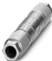
Prolongateur de câble, PROFINET, CAT5 (100 MBit/s), 4 pôles, exempt d'halogène, blindé, raccordement autodénudant, matière du boîtier : zinc moulé, nickelé, diamètre extérieur du câble de 5 mm à 9,7 mm 9,7 mm
