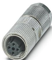
Connecteur de données, PROFINET CAT5 (100 Mbit/s), 4-pôles, blindé, connecteur femelle droit M12, D, Raccordement à sertir, matériau de la molette: Zinc moulé sous pression, étamé, diamètre extérieur du câble 4,5 mm ... 7,5 mm, sans contacts à sertir
