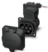
CHARX connect modular, Prise côté infrastructure, Rectangulaire, Basic, Kit, avec capot de protection carré, pour la charge en courant alternatif (AC) des véhicules électriques (VE), Type 2, CEI 62196-2, 32 A / 480 V (AC), sans fils individuels, actionneur de verrouillage: 12 V, 3 pôles, Montage sur la paroi arrière, Filetage M5, boîtiers: noir, Logo PHOENIX CONTACT
