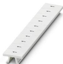
Ruban de repérage ZB, Rubans, blanc, repéré, repérable avec : CMS-P1-PLOTTER, impression longitudinale: chiffres identiques 1 ou 2, etc. jusqu'à 100, type de montage: encliquetage, pour bloc de jonction au pas de : 6,2 mm, surface utile: 6,15 x 10,5 mm, Nombre d'étiquettes: 10
