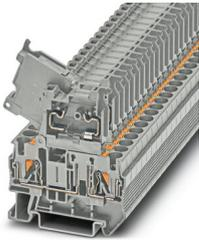
Bloc de jonction-fusibles, type de fusible: Verre / Céramique / ..., type de fusible: G / 5 x 20, tension nominale: 500 V, intensité nominale: 6,3 A, type de raccordement: Raccordement Push-in, Section de référence: 4 mm<sup>2</sup>, section : 0,2 mm<sup>2</sup>- 6 mm<sup>2</sup>, type de montage: NS 35/7,5, NS 35/15, coloris: gris
