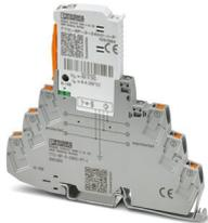
Parafoudre basse tension comprenant une fiche de protection et un élément de base à indicateur d'état intégré, destiné à un circuit de signalisation à 3 fils indépendant du potentiel de terre, à intensité nominale élevée, homologation EX e pour zone 2, compatible HART.
