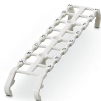
Repères pour blocs de jonction, blanc, repéré, type de montage: encliquetage, pour bloc de jonction au pas de : 8 mm, surface utile: 2,4 x 9,2 mm, Nombre d'étiquettes: 8
