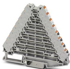
Connecteurs sous-répartiteurs, tension nominale: 250 V, intensité nominale: 8 A, type de raccordement: Raccordement Push-in, 1., 2., 3., 4., 5., 6., 7. und 8. Etage, Section de référence: 1,5 mm<sup>2</sup>, section : 0,14 mm<sup>2</sup> - 2,5 mm<sup>2</sup>, montage: NS 35/7,5, NS 35/15, coloris: gris, couleur des éléments de raccordement: blanc
