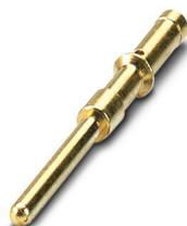
Contact à sertir, diamètre de contact: 1 mm, tournés, Mâle, matériau de contact: CuZn, surface des contacts: Ni/Au, section raccordable: 0,14 mm<sup>2</sup> ... 0,34 mm<sup>2</sup>, AWG 26 ... 22
