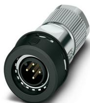
Connecteur, Universel, 5-pôles, blindé, connecteur mâle droit M12 Push-Pull, A, Raccordement à sertir, matériau de la molette: PA 6.6, diamètre extérieur du câble 4,5 mm ... 7,5 mm, sans contacts à sertir
