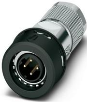
Connecteur de données, PROFINET CAT5 (100 Mbit/s), 4-pôles, blindé, connecteur mâle droit M12 Push-Pull, D, Raccordement à sertir, matériau de la molette: PA 6.6, diamètre extérieur du câble 4,5 mm ... 7,5 mm, sans contacts à sertir
