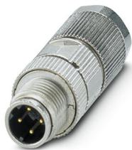
Connecteur de données, PROFINET CAT5 (100 Mbit/s), 4-pôles, blindé, connecteur mâle droit M12, D, Raccordement à sertir, matériau de la molette: Zinc moulé sous pression, étamé, diamètre extérieur du câble 4,5 mm ... 7,5 mm, sans contacts à sertir
