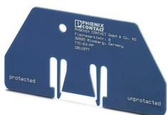
Séparateur pour profilés NS-35/7,5 pour assurer un écart de 50 mm entre le module de signalisation à distance et le parafoudre basse tension dans les systèmes TTC-EX.
