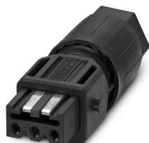
Connecteur, Raccordement QUICKON, nombre de pôles: 3+PE, 400 V, 16 A AC, noir, avec un écrou QUICKON, diamètre extérieur du câble: 7 mm ... 13 mm
