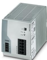
Alimentation TRIO, à synchronisation primaire, pour montage sur profilé, entrée : triphasée, sortie : 24 V DC / 40 A, réserve de puissance dynamique, raccordement autodénuant sans outil pour câbles rigides et flexibles munis d'embouts
