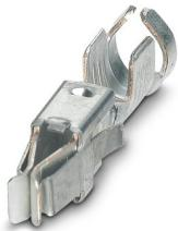
Contact femelle modulaire, à enfiler dans le capot PCC ou HCC du connecteur après sertissage du conducteur, pour conducteur entre 0,5 et 1,0 mm<sup>2</sup>
