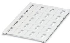
Repère pour conducteur, Planche, blanc, vierge, repérable avec : BLUEMARK ID COLOR, BLUEMARK ID, BLUEMARK CLED, PLOTMARK, CMS-P1-PLOTTER, type de montage: clipsage, plage de diamètre de câble: 2,8 ... 4,4 mm, surface utile: 15 x 5,5 mm, Nombre d'étiquettes: 15
