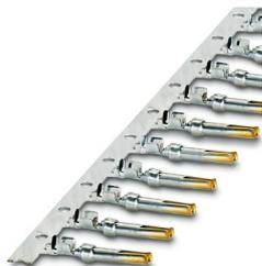
Contact à sertir, Connecteur femelle, roulés, Produits en bande, nombre de pièces par bande: 10000, diamètre de contact: 1 mm, zone de sertissage: 0,08 mm<sup>2</sup> ... 0,22 mm<sup>2</sup>
