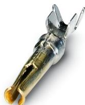
Contact à sertir, Connecteur femelle, roulés, Contact unique, diamètre de contact: 1 mm, zone de sertissage: 0,22 mm<sup>2</sup> ... 0,56 mm<sup>2</sup>, Contact individuel, L'article est sans plomb, conformément à la directive RoHS II, sans exception 6c (Pb < 0,1 %)
