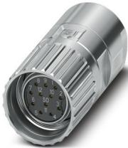
M23, Connecteurs à câble, série: M23 PRO, droit, blindé: oui, Verrouillage à vis, Nombre de pôles: 12, Sens de rotation: inversé, type de contact: Connecteur femelle, Raccordement à sertir, plage de diamètre de câble: 6 mm ... 10 mm, détrompage: N, L'article est sans plomb, conformément à la directive RoHS II, sans exception 6c (Pb < 0,1 %)
