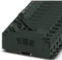
Bloc de jonction-fusibles, type de fusible: Verre / Céramique / ..., type de fusible: gG / gPV / 10,3 x 85, tension nominale: 1500 V DC, intensité nominale: 32 A, type de raccordement: Raccordement vissé, Section de référence: 16 mm<sup>2</sup>, section : 2,5 mm<sup>2</sup>- 25 mm<sup>2</sup>, type de montage: NS 35/7,5, NS 35/15, coloris: noir
