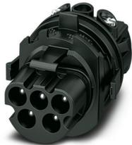
Porta-contatos, Famille d'articles: PRC 35, matériau du boîtier: PPE, coloris: noir, nombre de pôles: 5, section de fil min.: 1,5 mm<sup>2</sup>, section de fil max.: 6 mm<sup>2</sup>, tension de référence: 690 V AC, courant de référence: 35 A, Type de raccordement: Raccordement vissé, Type de contact: Mâle. Élément de contact sans boîtier de connecteur. Prière de commander le boîtier de connecteur adapté conformément à la liste des accessoires.
