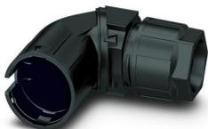
Capot pour connecteur, Famille d'articles: PRC 35, matériau du boîtier: PPE, coloris: noir, tension de référence: 690 V AC, diamètre de câble min.: 8 mm, diamètre de câble max.: 21 mm. Boîtier de connecteur sans élément de contact. Prière de commander les éléments de contact adaptés conformément à la liste des accessoires
