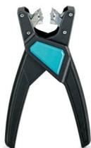
Pince à dénuder, pour câbles de capteurs et d'actionneurs exempts d'halogène (câbles SAC), avec isolation PUR et PVC, Ø de 3,2 mm à 4,4 mm, longueur à dénuder au choix
