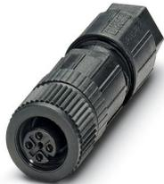
Connecteur de données, CANopen<sup>®</sup>, DeviceNet<sup>™</sup>, 5-pôles, non blindé, connecteur femelle droit M12, détrompage: A, Raccordement à ressort Push-Lock, matériau de la molette: Plastique, diamètre extérieur du câble 4 mm ... 8 mm
