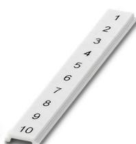
Ruban de repérage ZB, plat, Rubans, blanc, repéré, impression transversale: numérotation continue 1 ... 10, 11 ... 20, etc. jusqu'à 91 ... 100, type de montage: encliquetage, pour bloc de jonction au pas de : 5 mm, surface utile: 5,15 x 5,15 mm, Nombre d'étiquettes: 10
