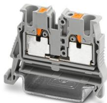
Bloc de jonction miniature, tension nominale: 800 V, intensité nominale: 24 A, nombre de connexions: 2, nombre de pôles: 1, type de raccordement: Raccordement Push-in, Section de référence: 2,5 mm<sup>2</sup>, section : 0,14 mm<sup>2</sup> - 4 mm<sup>2</sup>, type de montage: NS 35/7,5, NS 35/15, coloris: gris
