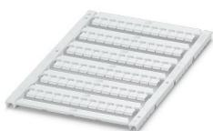
Repères pour blocs de jonction, à commander : sous forme de plaque, blanc, impression selon les indications du client, type de montage: encliquetage dans la rainure de repérage plate, pour bloc de jonction au pas de : 5,2 mm, surface utile: 4,4 x 4,7 mm, Nombre d'étiquettes: 72
