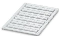
Repères pour blocs de jonction, Plaque, blanc, vierge, repérable avec : TOPMARK NEO, LASER TOPMARK, BLUEMARK ID COLOR, BLUEMARK ID, BLUEMARK CLED, THERMOMARK PRIME, THERMOMARK CARD 2.0, THERMOMARK CARD, type de montage: encliquetage, pour bloc de jonction au pas de : 5,2 mm, surface utile: 4,4 x 4,7 mm, Nombre d'étiquettes: 72
