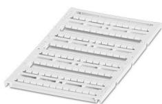
Repères pour blocs de jonction, Plaque, blanc, vierge, repérable avec : BLUEMARK ID COLOR, BLUEMARK ID, BLUEMARK CLED, PLOTMARK, CMS-P1-PLOTTER, type de montage: encliquetage, pour bloc de jonction au pas de : 5,2 mm, surface utile: 4,6 x 5,1 mm, Nombre d'étiquettes: 96
