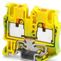
Bloc de jonction pour conducteur protection miniature, nombre de connexions: 2, nombre de pôles: 1, type de raccordement: Raccordement Push-in, Section de référence: 2,5 mm<sup>2</sup>, section : 0,14 mm<sup>2</sup> - 4 mm<sup>2</sup>, type de montage: NS 15, coloris: vert/jaune
