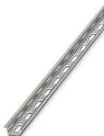
Profilé percé, Conditionnement par 10 unités (20 m), selon EN 60715, matériau: Aluminium, aucun revêtement, Profil standard, coloris: argenté
