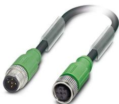
Câble pour capteurs/actionneurs, 5-pôles exempt d'halogène, blindé, connecteur mâle droit M12, détrompage: A, câblé avec déconnecté, sur Connecteur femelle droit M12, détrompage: A, longueur de câble: 3 m
