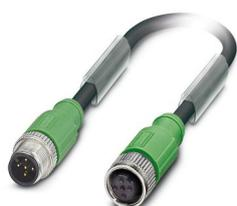
Câble pour capteurs/actionneurs, 5-pôles exempt d'halogène, blindé, connecteur mâle droit M12, détrompage: A, câblé avec déconnecté, sur Connecteur femelle droit M12, détrompage: A, longueur de câble: 0,6 m
