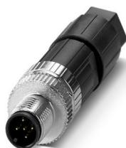
Connecteur, Universel, 5-pôles, non blindé, connecteur mâle droit M12, détrompage: A, Raccordement à ressort Push-Lock, matériau de la molette: Zinc moulé sous pression, nickelé, diamètre extérieur du câble 4 mm ... 8 mm
