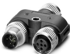
Répartiteur en Y, 5-pôles, blindé, Connecteur femelle droit M12 SPEEDCONNEC, détrompage: A, sur Connecteur femelle droit M12 SPEEDCONNEC, détrompage: A et connecteur mâle droit M12 SPEEDCONNEC, détrompage: A, Répartiteur parallèle
