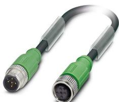
Câble pour capteurs/actionneurs, 5-pôles exempt d'halogène, blindé, connecteur mâle droit M12, détrompage: A, câblé avec déconnecté, sur Connecteur femelle droit M12, détrompage: A, longueur de câble: 0,3 m
