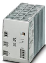
Convertisseur DC/DC à découpage primaire TRIO POWER avec raccordement Push-in pour le montage sur rail DIN, entrée : 1 500 V DC, sortie : 24 V DC/8 A
