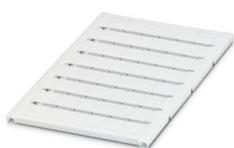
Repères pour blocs de jonction, Plaque, blanc, vierge, repérable avec : BLUEMARK ID COLOR, BLUEMARK ID, BLUEMARK CLED, PLOTMARK, CMS-P1-PLOTTER, type de montage: encliquetage, pour bloc de jonction au pas de : 10,2 mm, surface utile: 9,6 x 10,5 mm, Nombre d'étiquettes: 48
