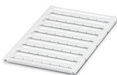
Repères pour blocs de jonction, Plaque, blanc, vierge, repérable avec : BLUEMARK ID COLOR, BLUEMARK ID, BLUEMARK CLED, PLOTMARK, CMS-P1-PLOTTER, type de montage: encliquetage, pour bloc de jonction au pas de : 10,2 mm, surface utile: 9,6 x 5,1 mm, Nombre d'étiquettes: 48
