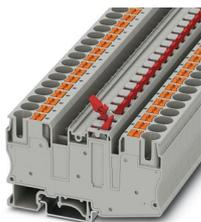
Bloc de jonction à couteau de sectionnement, tension nominale: 500 V, intensité nominale: 20 A, type de raccordement: Raccordement Push-in, Section de référence: 10 mm<sup>2</sup>, section : 0,5 mm<sup>2</sup> - 16 mm<sup>2</sup>, montage: NS 35/7,5, NS 35/15, NS 32, coloris: gris
