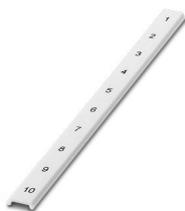
Ruban de repérage ZB, plat, Rubans, blanc, repéré, impression transversale: numérotation continue 1 ... 10, 11 ... 20, etc. jusqu'à 91 ... 100, type de montage: encliquetage, pour bloc de jonction au pas de : 10 mm, surface utile: 5,15 x 10 mm, Nombre d'étiquettes: 10
