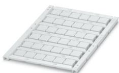
Repères pour blocs de jonction, Plaque, blanc, vierge, repérable avec : TOPMARK NEO, LASER TOPMARK, BLUEMARK ID COLOR, BLUEMARK ID, BLUEMARK CLED, THERMOMARK PRIME, THERMOMARK CARD 2.0, THERMOMARK CARD, type de montage: encliquetage, pour bloc de jonction au pas de : 10,2 mm, surface utile: 8,9 x 9,6 mm, Nombre d'étiquettes: 36
