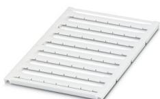
Repères pour blocs de jonction, à commander : sous forme de planche, blanc, impression selon les indications du client, type de montage: encliquetage dans la rainure de repérage plate, pour bloc de jonction au pas de : 10,2 mm, surface utile: 9,6 x 5,1 mm, Nombre d'étiquettes: 48
