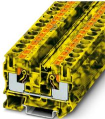
Blocs de jonction simple, tension nominale: 1000 V, intensité nominale: 57 A, nombre de connexions: 2, type de raccordement: Raccordement Push-in, Section de référence: 10 mm<sup>2</sup>, section : 0,5 mm<sup>2</sup> - 16 mm<sup>2</sup>, type de montage: NS 35/7,5, NS 35/15, coloris: noir/jaune
