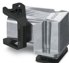
Embase COM, avec étrier longitudinal, matériau: Aluminium coulé sous pression, résistant à l'eau de mer, hauteur: 37,5 mm, presse-étoupe: sans, Standard
