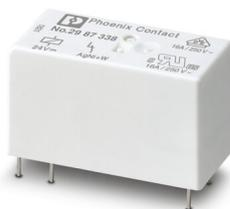
Relais de puissance miniature enfichable, avec contact en tungstène pour courants d'enclenchement élevés jusqu'à 800 A en pointe, 1 contact NO, tension d'entrée : 24 V DC
