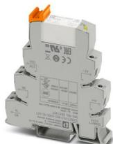
PLC-INTERFACE pour courants d'enclenchement élevés, comprend le bloc de jonction de base PLC-BSC.../1 IC/ACT à raccordement vissé, et un relais miniature enfichable pour montage sur rail DIN NS 35/7,5, courant d'enclenchement max. jusqu'à 800 A, 1 contact NO, tension d'entrée 24 V DC
