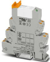
PLC-INTERFACE pour courants d'enclenchement élevés, comprenant un module de base PLC-BPT.../1 IC/ACT avec raccordement Push-in et un relais miniature enfichable, pour montage sur profilé NS 35/7,5, courant d'enclenchement max. jusqu'à 130 A, 1 contact NO, tension d'entrée : 12 V DC
