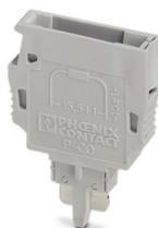
Fiches de composants, pour le montage de composants à choisir soi-même, tension nominale: 250 V, intensité nominale: 6 A, type de raccordement: Raccord enfichable, pas: 5,2 mm, profondeur: 33,2 mm, largeur: 5,1 mm, hauteur: 24,2 mm, nombre de pôles: 1, coloris: gris, type de montage: Enfichable (fente)
