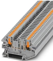
Bloc de jonction à fonction, L'intensité et la tension sont fonction de la fiche utilisée., tension nominale: 400 V, intensité nominale: 20 A, type de raccordement: Raccordement Push-in, Section de référence: 2,5 mm<sup>2</sup>, section : 0,14 mm<sup>2</sup> - 4 mm<sup>2</sup>, montage: NS 35/7,5, NS 35/15, coloris: gris
