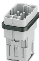
Élément de contact, nombre de pôles: 8+PE, taille: COM, contacts de puissance: 8, contacts de commande: 0, nombre de raccordements par pôle: 1, Mâle, Raccordement Push-in, 320 V, 16 A, 0,5 mm<sup>2</sup> ... 2,5 mm<sup>2</sup>, application: Puissance
