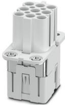
Élément de contact, nombre de pôles: 8+PE, taille: COM, contacts de puissance: 8, contacts de commande: 0, nombre de raccordements par pôle: 1, Connecteur femelle, Raccordement Push-in, 320 V, 16 A, 0,5 mm<sup>2</sup> ... 2,5 mm<sup>2</sup>, application: Puissance
