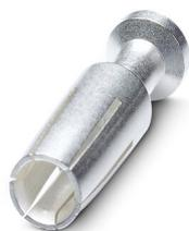
Contact à sertir, diamètre de contact: 4 mm, tournés, Connecteur femelle, matériau de contact: Alliage de cuivre, sans plomb, surface des contacts: plaqué argent, section raccordable: 10 mm<sup>2</sup> ... 10 mm<sup>2</sup>, AWG 8
