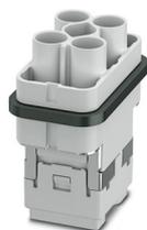
Élément de contact, nombre de pôles: 4+2+PE, taille: COM, contacts de puissance: 4, contacts de commande: 2, nombre de raccordements par pôle: 1, Mâle, Raccordement à sertir, 400 V, 40 A, 1,5 mm<sup>2</sup> ... 6 mm<sup>2</sup>, application: Puissance / signal
