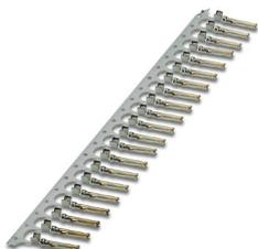
Contact à sertir, diamètre de contact: 1,6 mm, roulés, Connecteur femelle, matériau de contact: Alliage Cu, nickelé, surface des contacts: plaqué argent, section raccordable: 1,5 mm<sup>2</sup> ... 2,5 mm<sup>2</sup>, AWG 16 ... 14, Produits en bande
