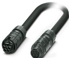
Câble de liaison, Famille d'articles: PRC 35, matériau du boîtier: PPE, coloris: noir, nombre de pôles: 5, tension de référence: 690 V AC, courant de référence: 32 A, Type de raccordement: Raccordement vissé, Type de contact: Connecteur femelle/mâle. Cet article est également disponible avec d'autres longueurs de câbles. Pour vos besoins, veuillez contacter votre filiale locale de PHOENIX CONTACT.
