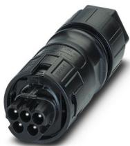
Connecteur, Famille d'articles: PRC 35, type: Déverrouillage avec un outil ou à la main (voir accessoires), matériau du boîtier: PPE, coloris: noir, nombre de pôles: 5, section de fil min.: 1,5 mm<sup>2</sup>, section de fil max.: 6 mm<sup>2</sup>, tension de référence: 690 V AC, courant de référence: 35 A, Type de raccordement: Raccordement vissé, Type de contact: Mâle, diamètre de câble min.: 8 mm, diamètre de câble max.: 21 mm. Garantit la protection contre les contacts avec les doigts
