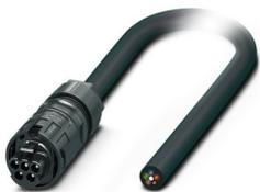
Câble de liaison, Famille d'articles: PRC 35, matériau du boîtier: PPE, coloris: noir, nombre de pôles: 5, tension de référence: 690 V AC, courant de référence: 32 A, Type de raccordement: Raccordement vissé, Type de contact: Mâle. Cet article est également disponible avec d'autres longueurs de câbles. Pour vos besoins, veuillez contacter votre filiale locale de PHOENIX CONTACT.
