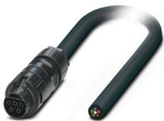
Câble de liaison, Famille d'articles: PRC 35, matériau du boîtier: PPE, coloris: noir, nombre de pôles: 5, section de fil max.: 2,5 mm<sup>2</sup>, tension de référence: 690 V AC, courant de référence: 32 A, Type de raccordement: Raccordement vissé, Type de contact: Connecteur femelle. Cet article est également disponible avec d'autres longueurs de câbles. Pour vos besoins, veuillez contacter votre filiale locale de PHOENIX CONTACT.
