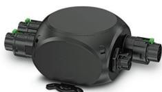
Répartiteur en H, Famille d'articles: PRC 35, type: Répartiteur en H, matériau du boîtier: Polycarbonate renforcé aux fibres de verre, coloris: noir, tension de référence: 400 V, courant de référence: 32 A, Type de raccordement: pré-équipé, Type de contact: Entrée : picot/sorties : connecteur femelle. Il est possible de configurer cet article. Pour la configuration, veuillez contacter votre filiale locale de Phoenix Contact.
