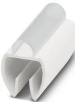
Repères pour fils, transparent, vierge, type de montage: clipsage, plage de diamètre de câble: 4,4 ... 6,7 mm, surface utile: 4 x 15 mm
