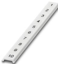
Ruban de repérage ZB, plat, Rubans, blanc, repéré, impression transversale: numérotation continue 1 ... 10, 11 ... 20, etc. jusqu'à 91 ... 100, type de montage: encliquetage, pour bloc de jonction au pas de : 6,2 mm, surface utile: 5,15 x 6,15 mm, Nombre d'étiquettes: 10
