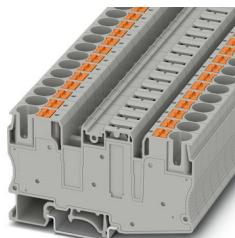
Bloc de jonction à fonction, L'intensité et la tension sont fonction de la fiche utilisée., tension nominale: 500 V, intensité nominale: 20 A, type de raccordement: Raccordement Push-in, Section de référence: 10 mm<sup>2</sup>, section : 0,5 mm<sup>2</sup> - 16 mm<sup>2</sup>, montage: NS 35/7,5, NS 35/15, coloris: gris
