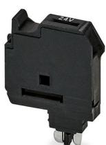
Fiche porte-fusible, Retirer la fiche porte-fusible du module de base avant de remplacer le fusible., tension nominale: 24 V, intensité nominale: 6,3 A, type de fusible: G / 5 x 20, type de montage: Montage par enfichage, coloris: noir
