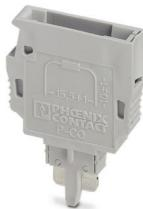
Fiches de composants, pour le montage de composants à choisir soi-même, tension nominale: 250 V, intensité nominale: 6 A, type de raccordement: Raccord enfichable, pas: 5,2 mm, profondeur: 33,2 mm, largeur: 5,1 mm, hauteur: 24,2 mm, nombre de pôles: 1, coloris: gris, type de montage: Enfichable (fente)
