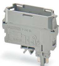
Fiches de composants, pour l'installation de composants au choix, d'un diamètre allant jusqu'à 10 mm et une perte de puissance de 1 W maximum, tension nominale: 400 V, intensité nominale: 10 A, type de raccordement: Raccord enfichable, profondeur: 37,5 mm, largeur: 12,3 mm, hauteur: 41,2 mm, nombre de pôles: 1, coloris: gris, type de montage: Enfichable (fente)
