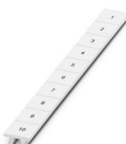
Ruban de repérage ZB, Rubans, blanc, repéré, repérable avec : CMS-P1-PLOTTER, impression transversale: numérotation continue 1 ... 10, 11 ... 20, etc. jusqu'à 91 ... 100, type de montage: encliquetage, pour bloc de jonction au pas de : 10,2 mm, surface utile: 10,15 x 10,5 mm, Nombre d'étiquettes: 10
