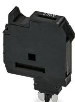
Fiche porte-fusible, Retirer la fiche porte-fusible du module de base avant de remplacer le fusible., tension nominale: 500 V, intensité nominale: 6,3 A, type de fusible: G / 5 x 20, type de montage: Montage par enfichage, coloris: noir
