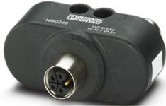
Répartiteur en Y, 5-pôles, blindé, connecteur mâle droit M12, détrompage: L, sur Connecteur femelle droit M12, détrompage: L et Connecteur femelle droit M12, détrompage: L, pour courant continu jusque 16 A / 63 V, Répartiteur parallèle
