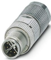
Connecteur de données, Ethernet CAT6<sub>A</sub> (10 Gbit/s), PROFINET CAT6<sub>A</sub> (10 Gbit/s), 8-pôles, blindé, connecteur mâle droit M12, détrompage: X, Raccordement à sertir, matériau de la molette: Zinc moulé sous pression, étamé, diamètre extérieur du câble 6,5 mm ... 10 mm, sans contacts à sertir
