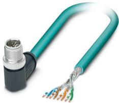
Câble de réseau, Ethernet CAT6<sub>A</sub> (10 Gbit/s) CAT6<sub>A</sub> (10 Gbit/s), 8-pôles exempt d'halogène, blindé (Advanced Shielding Technology), connecteur mâle coudé M12, détrompage: X / IP67, sur extrémité libre, longueur de câble: 10 m
