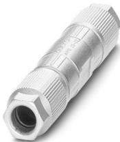
Prolongateur de câble, Ethernet CAT6<sub>A</sub> (10 GBit/s), 8 pôles, exempt d'halogène, blindé, raccordement autodénudant, matière du boîtier : zinc moulé, nickelé, diamètre extérieur du câble de 5 mm à 9,7 mm 9,7 mm
