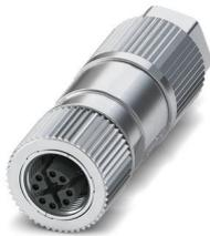
Connecteur de données, Ethernet CAT6<sub>A</sub> (10 Gbit/s), 8-pôles, exempt d'halogène, blindé, connecteur femelle droit M12, détrompage: X, Raccordement autodénudant, matériau de la molette: Zinc moulé sous pression, nickelé, diamètre extérieur du câble 5 mm ... 9,7 mm
