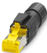
Connecteur RJ45, type: RJ45, indice de protection: IP20, nombre de pôles: 8, 10 Gbit/s, CAT6<sub>A</sub>, matériau: Plastique, type de raccordement: Raccordement autodénudant, section raccordable: AWG 26- 24, sortie du câble: droit, coloris: noir, Ethernet
