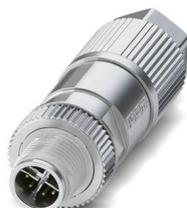
Connecteur de données, Ethernet CAT6<sub>A</sub> (10 Gbit/s), 8-pôles, exempt d'halogène, blindé, connecteur mâle droit M12, détrompage: X, Raccordement autodénudant, matériau de la molette: Zinc moulé sous pression, nickelé, diamètre extérieur du câble 5 mm ... 9,7 mm
