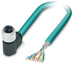
Câble de réseau, Ethernet CAT6<sub>A</sub> (10 Gbit/s) CAT6<sub>A</sub> (10 Gbit/s), 8-pôles exempt d'halogène, blindé (Advanced Shielding Technology), extrémité libre, sur Connecteur femelle coudé M12, détrompage: X / IP67, longueur de câble: 5 m
