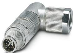
Connecteur de données, Ethernet CAT6<sub>A</sub> (10 Gbit/s), PROFINET CAT6<sub>A</sub> (10 Gbit/s), 8-pôles, blindé, connecteur mâle coudé M12, détrompage: X, Raccordement à sertir, matériau de la molette: Zinc moulé sous pression, étamé, diamètre extérieur du câble 6,5 mm ... 10 mm, sans contacts à sertir
