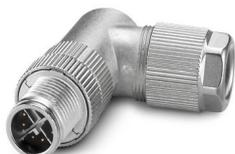
Connecteur de données, Ethernet CAT6<sub>A</sub> (10 Gbit/s), 8-pôles, blindé, connecteur mâle coudé M12 SPEEDCONNEC, détrompage: X, Raccordement rapide Piercecon<sup>®</sup>, matériau de la molette: Zinc moulé sous pression, nickelé, diamètre extérieur du câble 4 mm ... 8 mm
