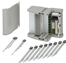
Termination Carrier universel pour raccorder 16 amplificateurs-séparateurs MINI Analog à des cartes d'entrée/sortie TOR ou analogiques, via des connecteurs D-SUB, 37 pôles (liaison 1:1), avec raccordement de multiplexeur HART
