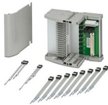
Termination Carrier universel pour la connexion de 16 amplificateurs-séparateurs MINI Analog à des cartes E/S TOR ou analogiques, via connecteurs D-SUB, 37 pôles (liaison 1:1)
