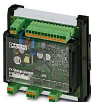
Le contrôleur de charge EV-DC-AC1-M3-CBC-SER-HS-MSTB avec boîtier pour le montage sur rail DIN et la technique de raccordement enfichable, sert à la recharge des véhicules électriques sur le réseau à courant alternatif triphasé selon la norme CEI 61851-1, Mode 3. Optimisé pour les stations de charge avec un connecteur de charge côté véhicule, monté en fixe. Toutes les fonctions de recharge et de vastes réglages de configuration sont déjà intégrés.
