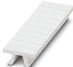
Ruban de repérage ZB, Rubans, blanc, vierge, repérable avec : PLOTMARK, CMS-P1-PLOTTER, type de montage: encliquetage, pour bloc de jonction au pas de : 3,5 mm, surface utile: 3,5 x 10,5 mm, Nombre d'étiquettes: 10
