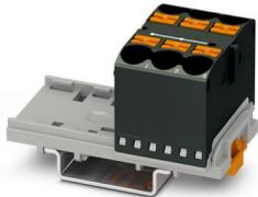
Bloc distributeur, Bloc avec orientation verticale, tension nominale: 800 V, intensité nominale: 57 A, nombre de connexions: 6, type de raccordement: Raccordement Push-in, Section de référence: 10 mm<sup>2</sup>, section : 0,5 mm<sup>2</sup> - 16 mm<sup>2</sup>, type de montage: NS 35/7,5, NS 35/15, coloris: noir
