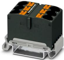
Bloc distributeur, Bloc avec orientation horizontale, tension nominale: 800 V, intensité nominale: 57 A, nombre de connexions: 6, type de raccordement: Raccordement Push-in, Section de référence: 10 mm<sup>2</sup>, section : 0,5 mm<sup>2</sup> - 16 mm<sup>2</sup>, type de montage: NS 35/7,5, NS 35/15, coloris: noir
