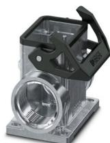
Embase en saillie B6, avec étrier longitudinal, matériau: Aluminium coulé sous pression, résistant à l'eau de mer, nombre de sorties: 2, latérale, 2x M25, hauteur: 74,8 mm, presse-étoupe: sans, Standard
