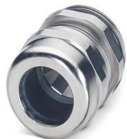
Presse-étoupe, matériau du raccordement vissé: Laiton, nickelé, diamètre extérieur du câble 19 mm ... 27 mm, blindage: oui, filetage de raccordement: M40 x 1,5, coloris: argenté, avec joint torique
